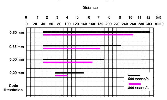
DS2100N-1X00 Reading Distance vs Scanning Speed
