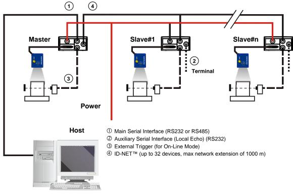
Figure 77 – ID-NET™ M/S Multidata with Serial Host
