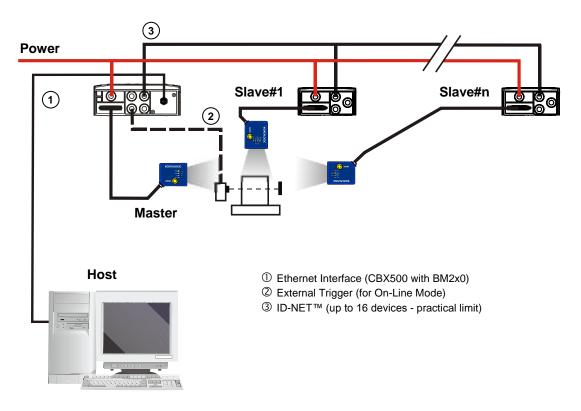
Figure 74 – ID-NET™ M/S Synchronized Layout DS2x00N Master with BM200/210 TCP/IP Ethernet Interface to Host
