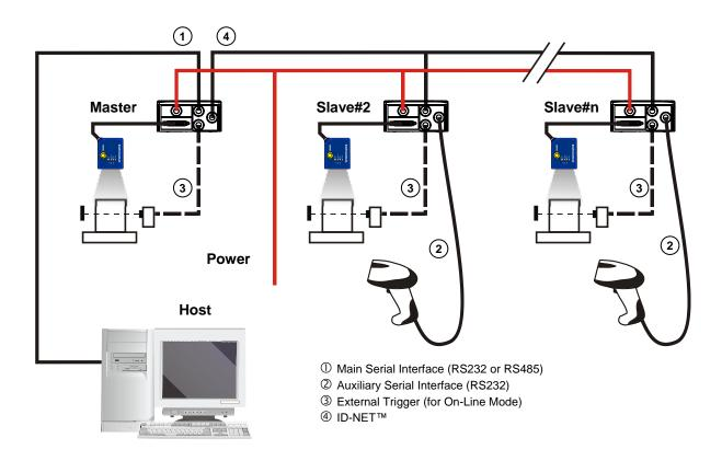
Figure 79 – Pass-Through On ID-NET™ Layout
