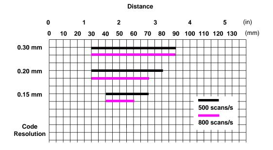
DS2100N-2X00 Reading Distance vs Scanning Speed
