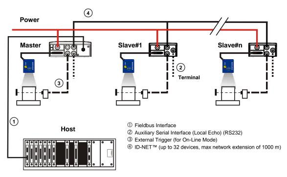
Figure 78 – ID-NET™ M/S Multidata with Fieldbus Host
