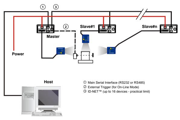
Figure 71 – ID-NET™ M/S Synchronized Layout
