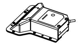
Figure 28 – Fixing DS2X00N Scanner to GFC-200
