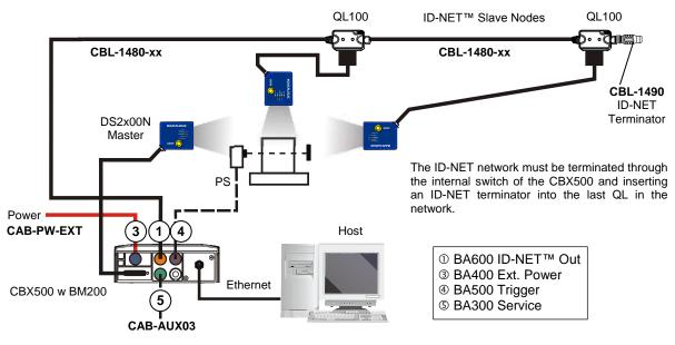
Figure 72 – ID-NET™ M/S Synchronized Layout DS2x00N Master with CBX500 + DS2x00N Slaves with QL100
