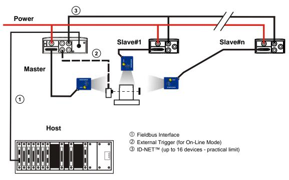
Figure 75 – ID-NET™ Fieldbus M/S Synchronized Layout
